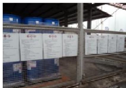
毒化物標示板詳細標示危害警告訊息及危害防範措施
